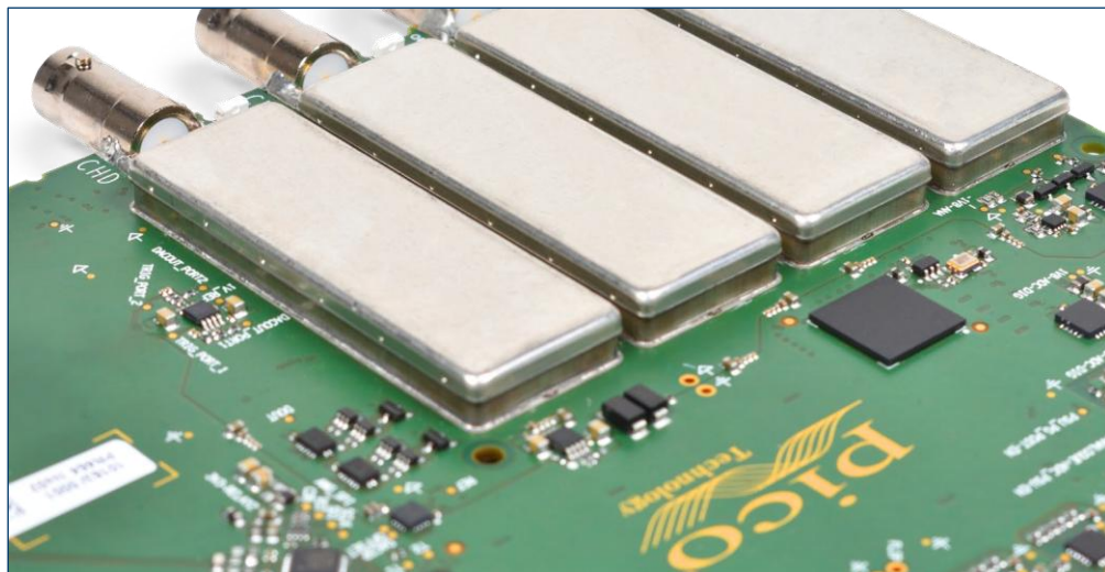
PicoScope 5000Eの高性能プリント基板。16ビット分解能を実現する高精度ADCと、超低ノイズフロア22 \mu V RMSを実現するシールド付きフロントエンドを搭載。
